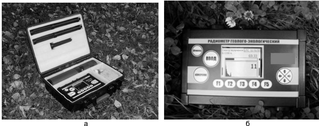
Рис. 3. Полевой радиометр: внешний вид (а); вид на главную панель (б)
