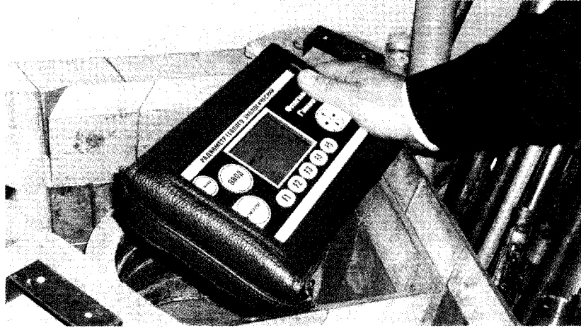
Рис. 5.1.3. Проведение измерений собственного фона прибора
